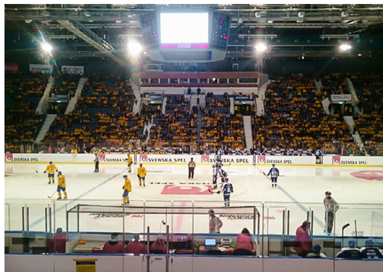
Konventionell ishallsbelysning Reflektion och mörka partier på isen
